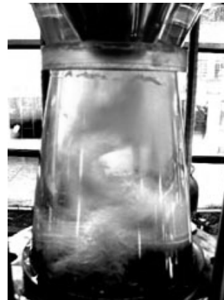
Fig.9. Vortex rope II
