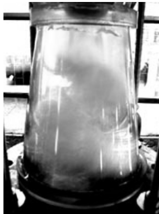
Fig.9. Vortex rope I
